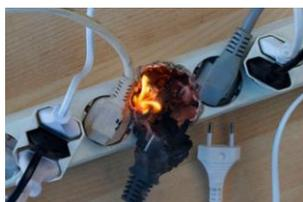
**Не подключайте** к одной штепсельной розетке одновременно несколько электроприборов. Перегрузка проводов грозит возникновением пожара.
